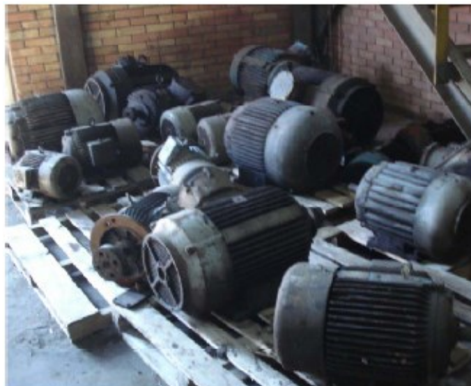
Слика 10. Демонтирана електроопрема (електро мотори)
